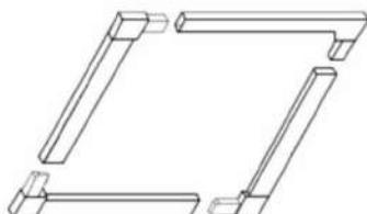
1) Скрепите основной профиль с помощью уголков. Уголки устанавливаются в профиль.
