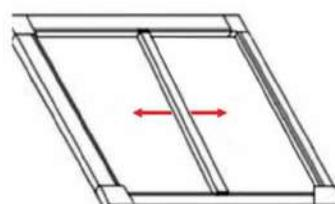
3) Соедините импост с рамным профилем с помощью двух кронштейнов. Установите импост по центру рамки.
